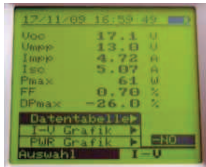
Das I-V 400 verfügt über eine große grafische Anzeige, von der alle notwendigen Messwerte gleichzeitig abgelesen werden können, um die Qualität der Solarmodule zu bestimmen
